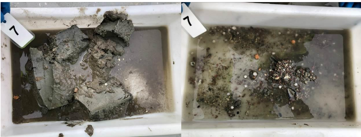
Figur 28: Bilder som viser sedimentet fra stasjon 7 før og etter siling. Sedimentet besto av silt og noe sand, leire og skjellsand. Det ble registrert fôrrester i denne prøven. Foto: Aqua Kompetanse AS.
